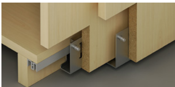
Направляюча шина для нижнього монтажу
